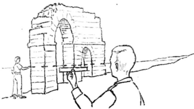
Рис. 6. Проведение нулевой линии на стенах здания по водному горизонту
