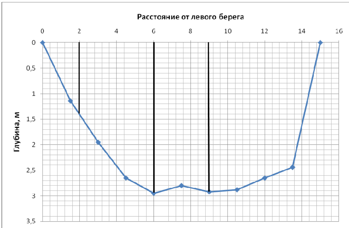
Рис. 10. Поперечный профиль р. Писса в районе г. Гусев выше слияния с р. Красной
