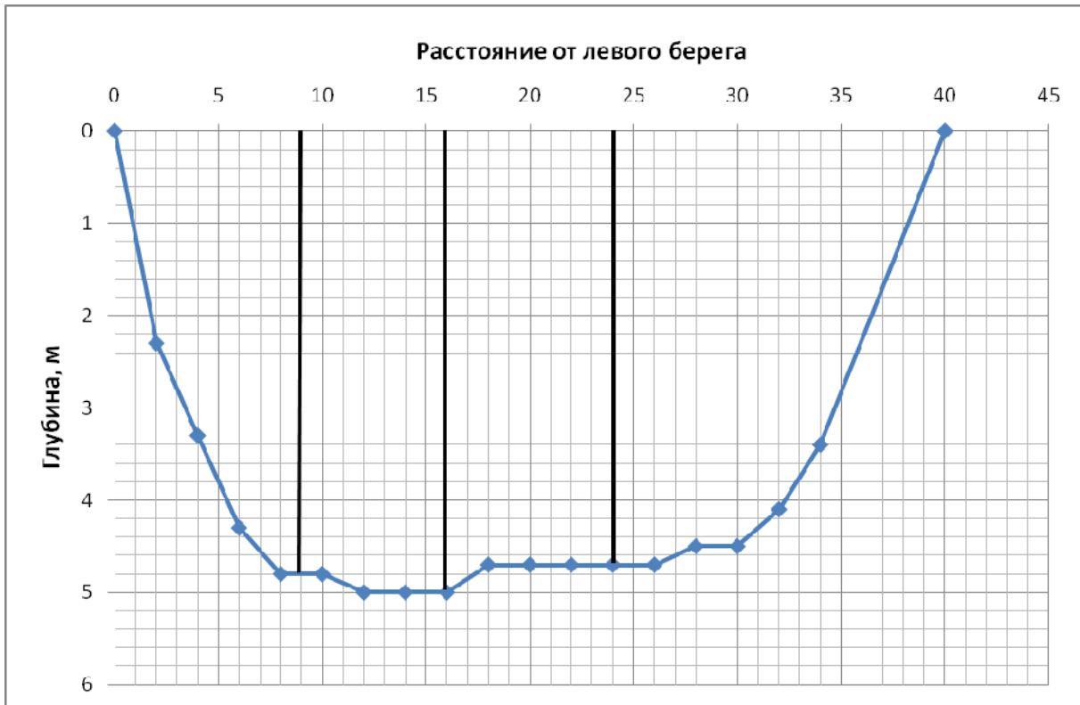
Рис. 11. Поперечный профиль р. Дейма в районе г. Гвардейск на расстоянии 100 метров выше ее впадения в р. Преголя
