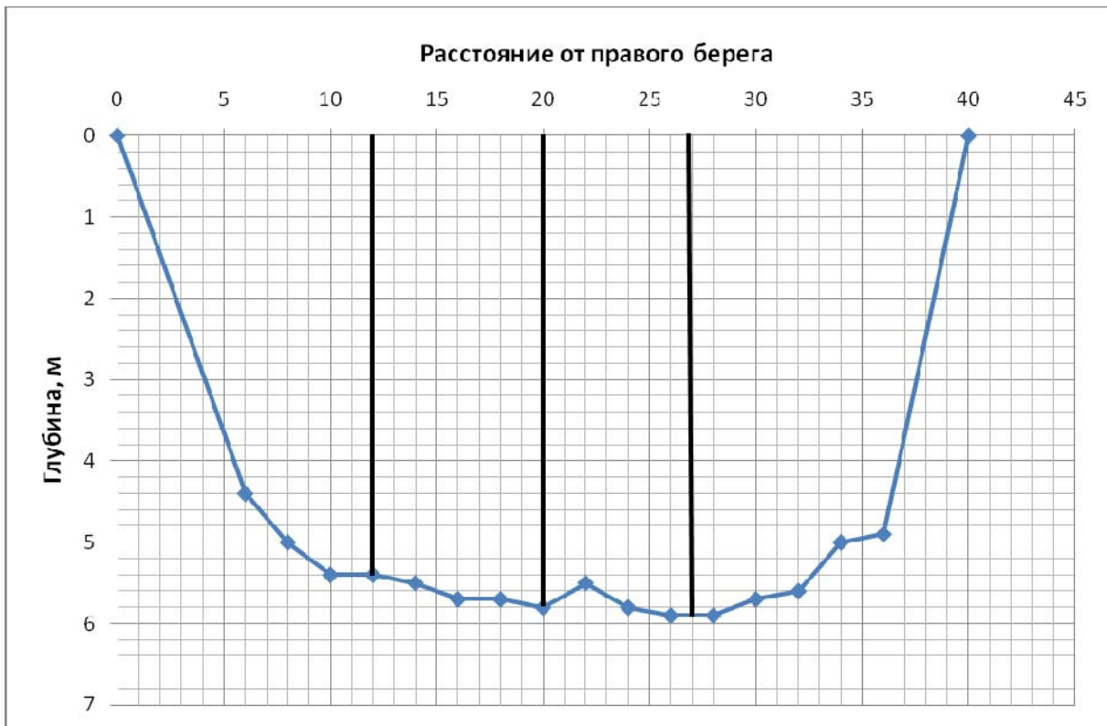
Рис. 12. Поперечный профиль р. Лава в районе г. Знаменск на расстоянии 100 метров выше ее впадения в р. Преголя
