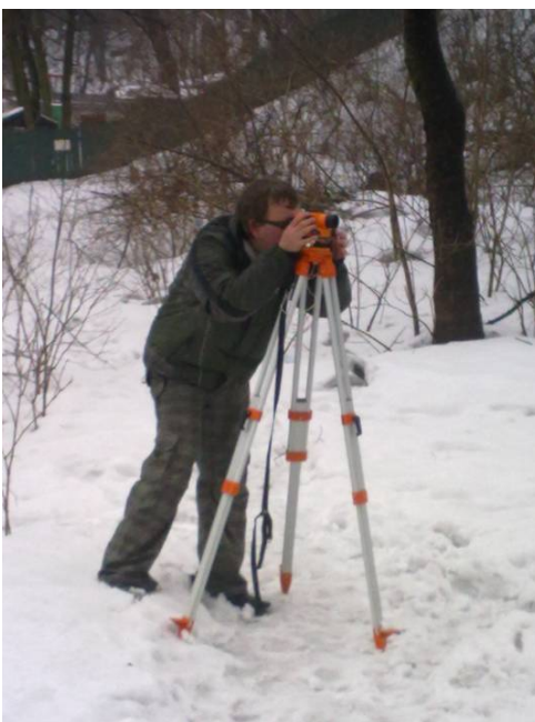
Рис. 2. Процесс нивелировки водомерного поста
