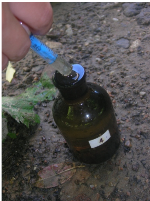
Рис. 5.6. Процесс фиксирования растворенного кислорода в пробе воды
