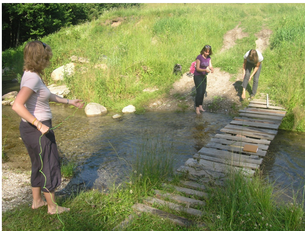
Рис.3.5. Построение поперечного профиля р. Черной
